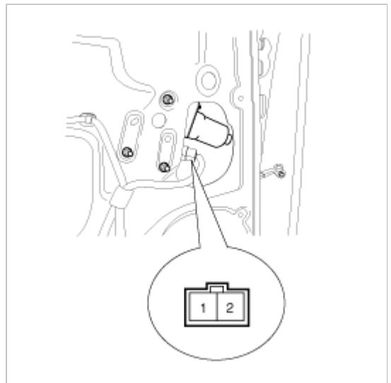
3. 如下表在电机端子上连接蓄电池电源（12V）和搭铁,检查电机工作是否正常,然后颠倒正负极,检查电机反方向转动是否正常。如果工作异常,更换电机。
